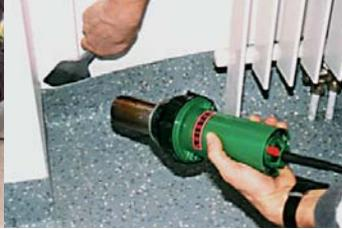
Аппарат горячего воздуха ЭЛЕКТРОН для формовки плиток, лент, плинтусов, углов, окантовок лестниц, а также для быстрой сушки нивелирующих масс и клеев.
