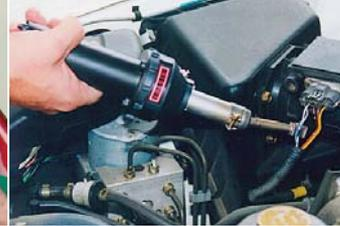
Аппарат ХОТ ДЖЕТ S с решетчатой рефлекторной насадкой при соединении электрокабеля с использованием термоусадочной муфты.
