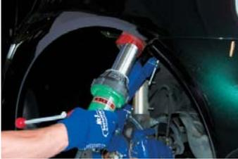
Использование аппарата ЭЛЕКТРОН для ускорения процесса сушки лака, краски и шпатлевки.
