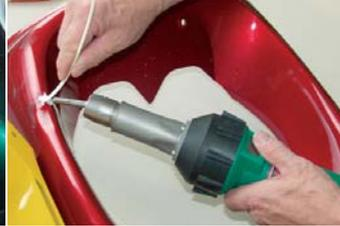
При использовании аппарата ТРИАК PID с электронной регулировкой температуры даже проблемный ремонт пластмассовых деталей не представляет трудностей.
