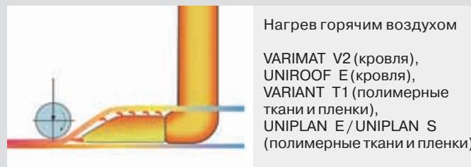
Сварочный автомат горячего клина (электронагрев горячего клина)
