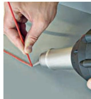
Оптимально для сварки с прутком при производстве изделий из пластмасс.
