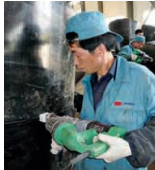
Экструдер FUSION 2 при сварке резервуара.
