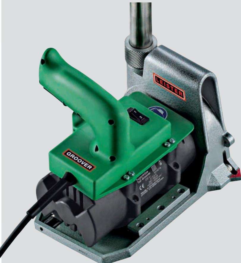
GROOVER расширяет швы в толстых и вязких напольных покрытиях из ПВХ-пласт., ПЭ и в линолеуме. Электрофреза скользит на трех роликах, что обеспечивает постоянство глубины расшивки шва даже на высокой скорости.
