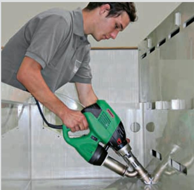
Ручной сварочный экструдер
