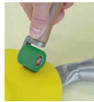
Простая сварка при использовании эргономичного ручного прикаточного ролика.
