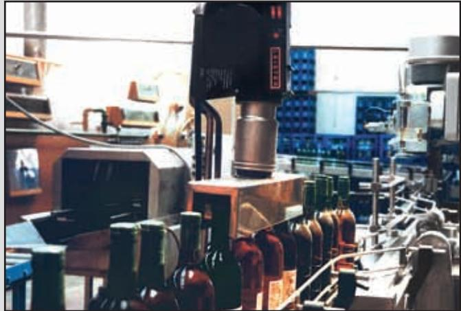
Хотвинд S с тоннельной насадкой, установленный на розливочной машине, при усадке колпачков.
