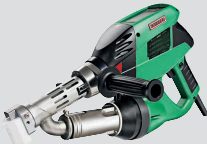
Экструдер WELDPLAST S2 с производительностью до 2,3 кг/ч, применяется в различных климатических условиях и труднодоступных местах. Используется для сварки конструкций из листового полиэтилена и полипропилена, гидроизоляции, ПЭ изоляции ППУ труб, безнапорных трубопроводов.
