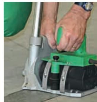
Мощный привод подходит для резки шва ПВХ, ПУ и линолеума.
