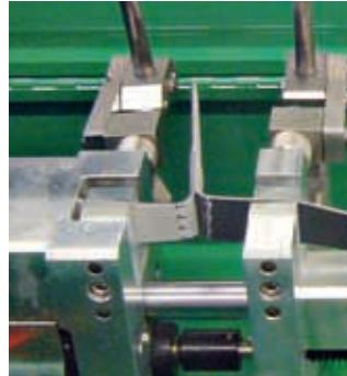
Испытание сварочного шва при помощи EXAMO USB.
