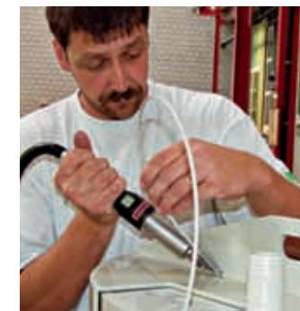
Сварка прутком с использованием компактного и легкого аппарата WELDING PEN R.
