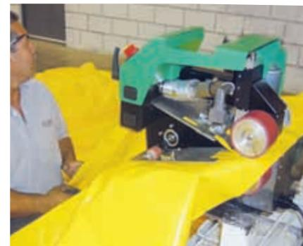
Стационарная сварочная машина горячего воздуха
