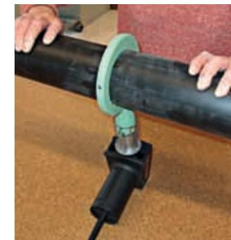
Сварка труб при помощи зеркальной насадки.
